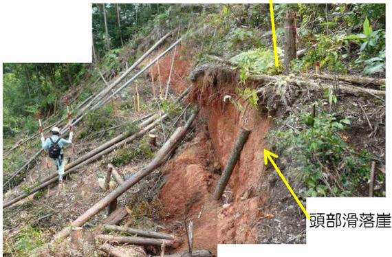
写真- 7 強風化変成岩の崩壊（八代市東陽町赤山）
